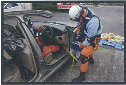
④ウェビングテープの長さを 調整しスプレッターで拡張
