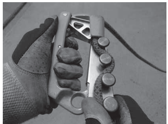
写真9 ロープコントローラの取付け
