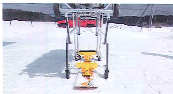
写真8 正面車輪とスノーボードを平行にすることにより安定する。
