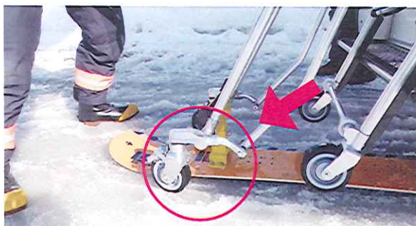
写真9 搬出時 ガイド板の凹部にストレッチャー脚フレームを挿入
