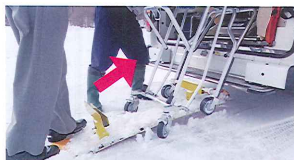
写真12 搬入時 アタッチメントからストレッチャー脚フレームが自動的に外れる。
