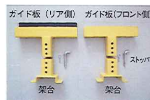
写真6 ストレッチャー・スノー・アタッチメントのパーツは「ガイド板」と「架台」からなり、高さ調整を3段階とした。特に、リア側の「ガイド板」を1段高くして、搬出入時にストレッチャーのフレームを脱着しやすくした。
