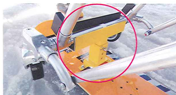
写真10 搬出時 ガイド板(リア側)を1段高くすることにより、ストレッチャー脚フレームが受けやすくなり装着がスムーズ。
