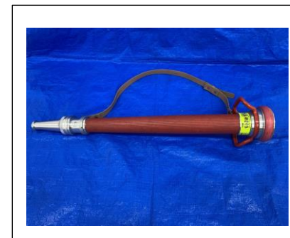
安全管そう (写真 10)
