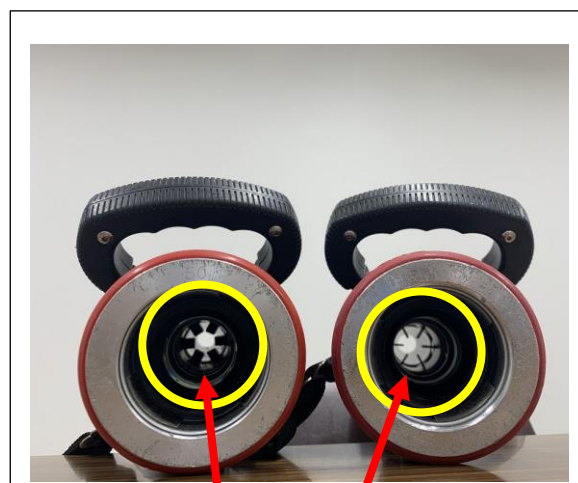
整流板「左は噴霧時、右は通常時」（写真16）
