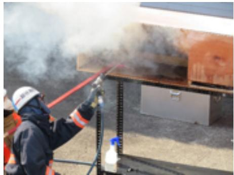
写真 2-5 ガスクーリングの効果を確認している様子
