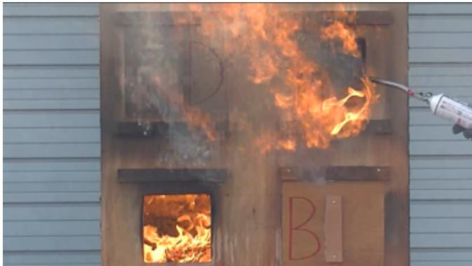
写真3－11 煙をガスバーナーにて着火した様子
