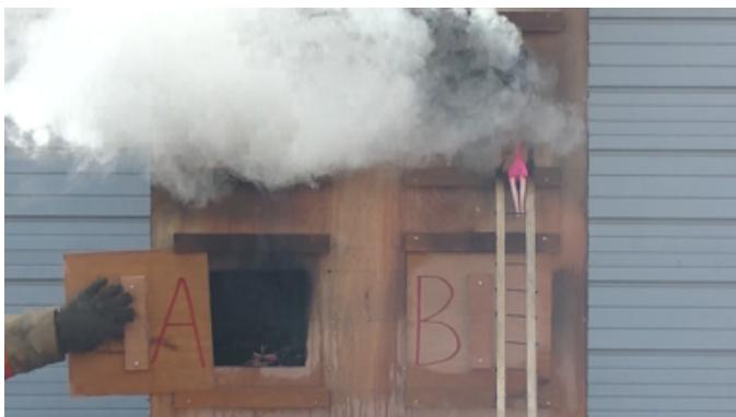
写真3-14 救出中にA室開口部を開放し流路が形成された状況
