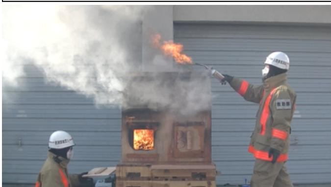
写真 3-18 垂直ベンチレーションの煙にガスバーナーにて着火している様子
