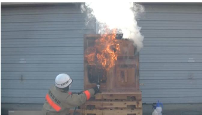
写真3－2 1 A室天井に向けてレイン注水を行っている状況
