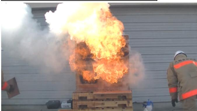
写真3－2 0 バックドラフトを発生させた状況
